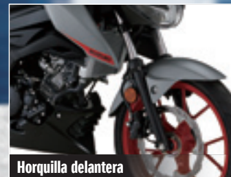
Disco de freno de perfil ondulado y deportiva llanta de fundición de aluminio
