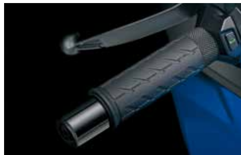
Puño Calefatable 57100-48822-000 Con tres niveles de calefacción. *Toda su superficie es calefactable.
